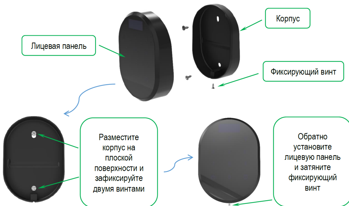
Рисунок 3 – Порядок установки кодовой панели
