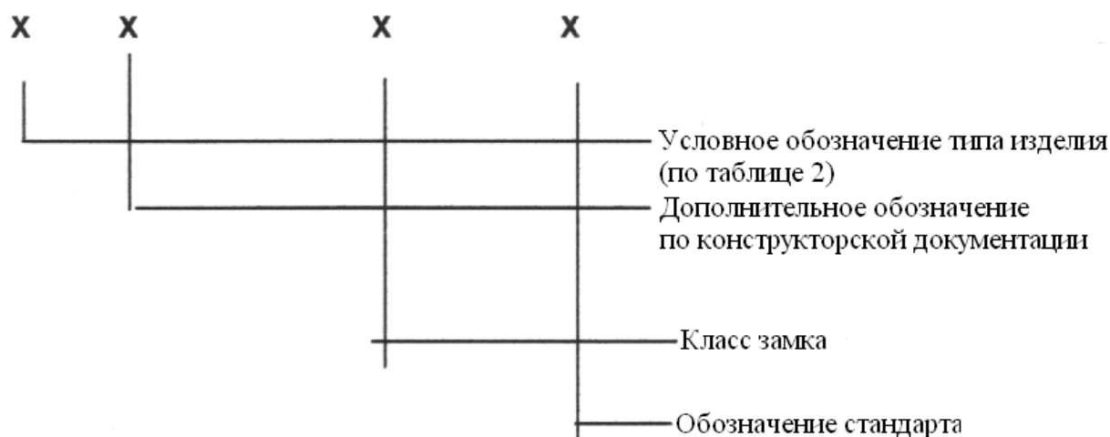
Рисунок 1 – Структура условного обозначения замков и защелок
