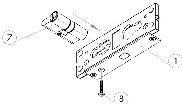
3. Собрать корпус замка на стекле в последовательности, как показано на рисунке ниже. При использовании стекла толщиной 10 мм установить уплотнитель ⑤ и проставку ④ (1 шт.) как показано на рисунке ниже. При использовании стекла толщиной 12 мм уплотнитель ⑤ не устанавливается.
