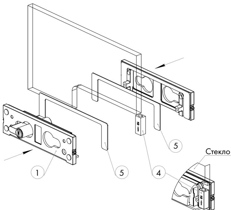
4. Зафиксировать корпус замка ① на стекле.
