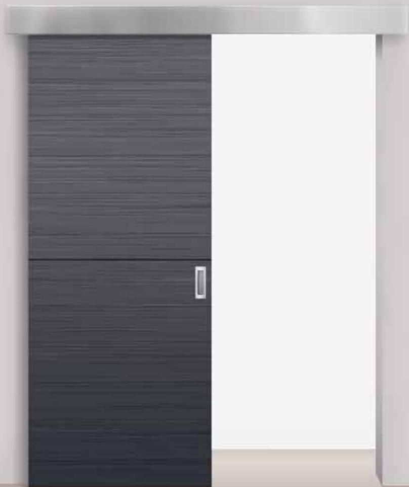
Comfort-PRO STANDART — подвесная роликовая система одностороннего открывания параллельно стене. Полный комплект для установки включает Comfort-PRO SET 1/rollers/80. Comfort-PRO SET 1/rollers/80 с двумя роликами рассчитана для установки на деревянные межкомнатные двери весом до 80 кг, толщиной полотна от 30 мм и шириной от 500 мм. Нейлоновые колеса с подшипниками гарантируют бесшумное скольжение по направляющим. Предусмотрена регулировка полотна относительно пола.
