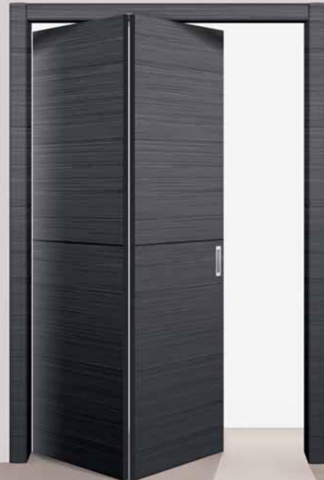
Складная система «книжка» — удачное решение для экономии свободного пространства в помещении. Система Folding предназначена для установки в стандартную дверную коробку на деревянные межкомнатные двери весом до 40 кг и толщиной полотна 40 мм. Универсальный механизм подходит для правого и левого открывания двери. В зависимости от вкуса и потребностей можно установить равные или ассиметричные двери, а если проем широкий — то двойные.
