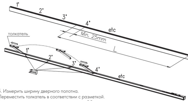
5. Измерить ширину дверного полотна. Переместить толкатель в соответствии с разметкой. Расстояние от толкателя до края спла min 25 mm.
