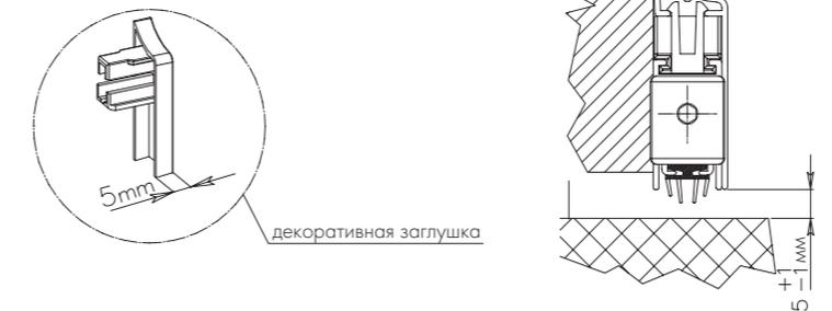
9. Установить крепежные элементы согласно схеме. Закрепить порог на дверном полотне с учетом Мах вылета уплотнителя 14 мм. В зависимости от расстояния между полом и дверным полотном, допускается установка профиля выше или ниже края полотна. Производитель рекомендует устанавливать порог на расстоянии 5 мм (± 1 мм) от пола.
