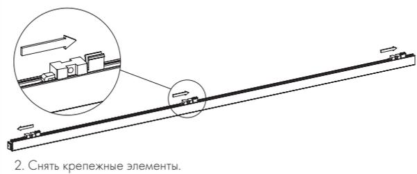
2. Снять крепежные элементы.
