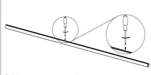
7. Зафиксировать механизм в профиле.
