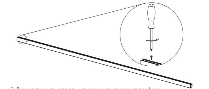
3. Выкрутить винты, разъединить механизм порога от профиля.
