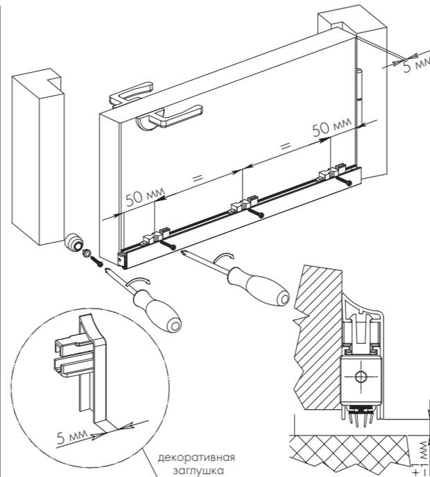
9. Установить крепежные элементы согласно схеме. Закрепить порог на дверном полотне с учетом Max вылета уплотнителя 14 мм. В зависимости от расстояния между полом и дверным полотном, допускается установка профиля выше или ниже края полотна. Производитель рекомендует устанавливать порог на расстоянии 5 мм (± 1 мм) от пола.
