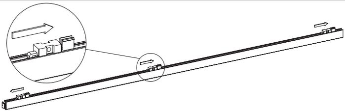
2. Снять крепежные элементы.
