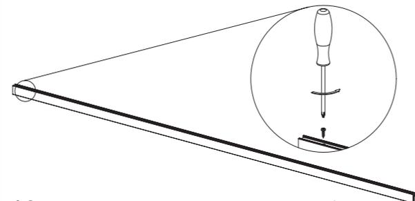
3. Выкрутить винты, разъединить механизм порога от профиля.
