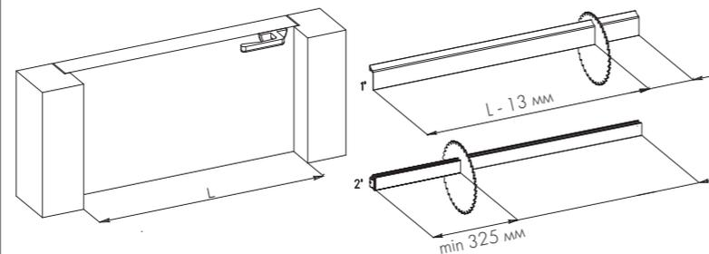
8. Отпилить декоративную накладку и профиль с механизмом на 13 мм короче ширины дверного полотна. Это место необходимо оставить для декоративной заглушки и технологического пространства, необходимого при закрывании двери.
