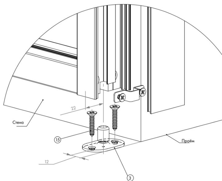
Зафиксировать нижний направляющий ролик (3) на полу с помощью саморезов (15).
