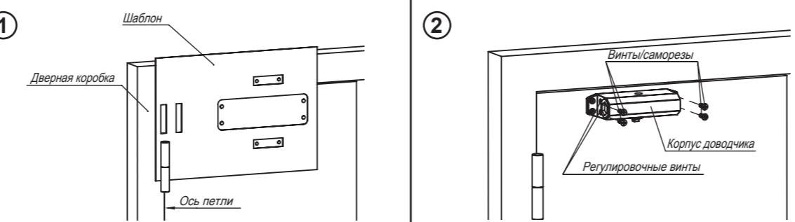
Совместите шаблон максимально точно по контуру дверного полотна/коробки и петель. Закрепите шаблон, например скотчем. Далее необходимо подготовить отверстия для установки доводчика.
