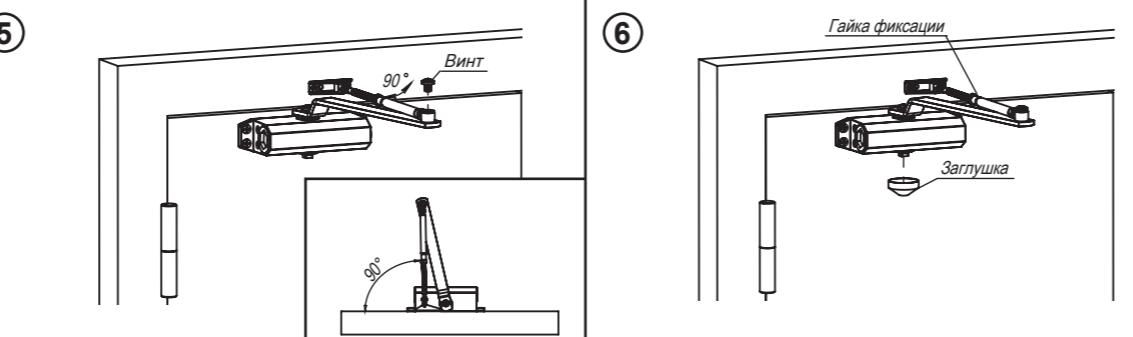
Выставьте длину регулируемого рычага, проворачивая винтовую часть по или против часовой стрелки. Установите и зафиксируйте соединительный винт.
