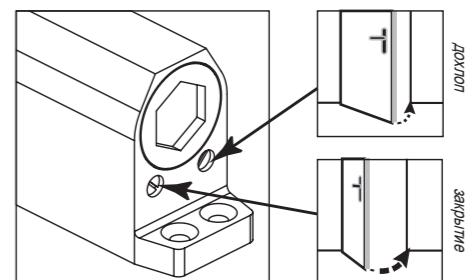
Закрытие дверного полотна в двух зонах регулируется винтами на корпусе доводчика:
