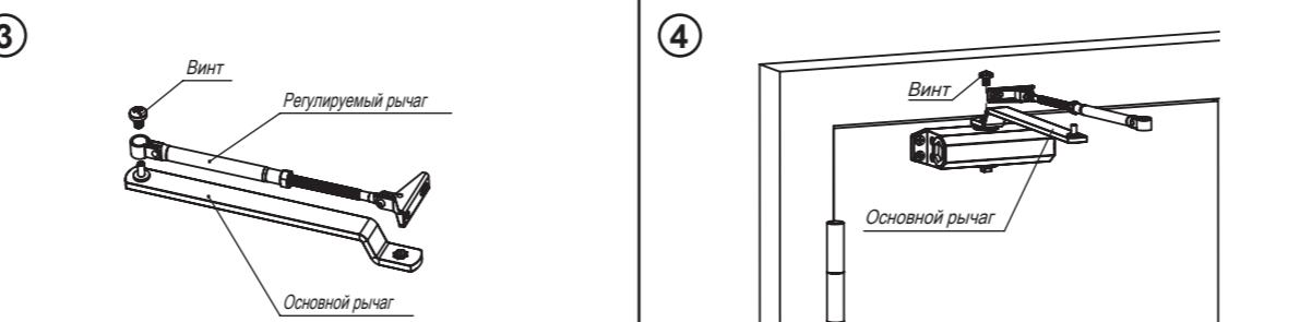
Детали рычажного механизма в комплекте поставки соединены между собой. Необходимо разъединить основной и регулируемый рычаг. После зафиксировать кронштейн рычага на дверном полотне или коробке (в зависимости от выбранного варианта).
