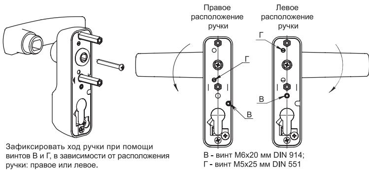
4 Установить и закрепить ручку на дверном полотне при помощи винтов M5x40. Установить окончательно ручки нажимные 1700B/1700C.
