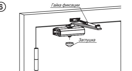
Зафиксируйте фиксирующую гайку на рычаге доводчика. Отверстие под винт, на корпусе с противоположной стороны доводчика, закройте декоративной заглушкой. Далее выполните регулировку доводчика.
