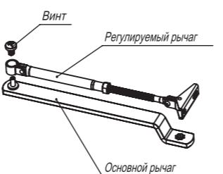
Детали рычажного механизма в комплекте поставки соединены между собой. Необходимо разъединить основной и регулируемый рычаг. После зафиксировать кронштейн рычага на дверном полотне или коробке (в зависимости от выбранного варианта).
