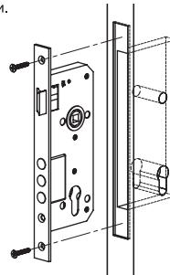
3. Установите цилиндр (A) и зафиксируйте его винтом (B).
