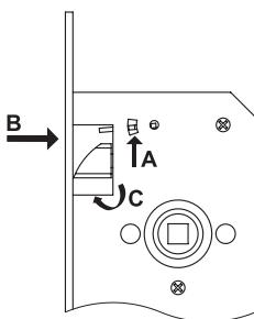
2. Нанесите разметку и сделайте выборку под корпус и лицевую планку в торце двери. На дверном полотне сделайте отверстия под цилиндровый механизм, квадрат ручки и винты крепления. После установите корпус замка в дверь и закрепите его саморезами.
