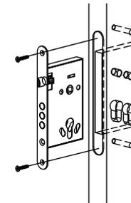
3. Установите цилиндр (A) (не входит в комплект). Зафиксируйте его винтом (B).
