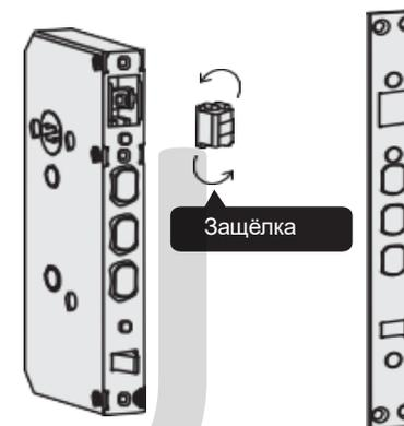
3. Установите заднюю лицевую панель и затяните винты, после чего работа выполнена.
