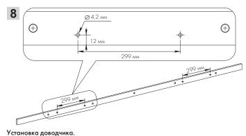
Все отверстия для монтажа на направляющей предусмотрены. В случае, если возникает необходимость обрезать направляющую под свой размер, нужно воспользоваться схемой на чертеже.
