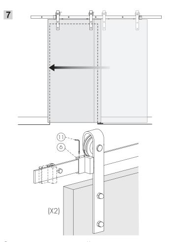
Определите крайние положения двери. Установите стопоры на направляющей относительно дверного проема и зафиксируйте их. Стопор может быть установлен как до первого крепления к стене, так и за ним. Для этого необходимо открутить крепежный винт и продвинуть стопор вдоль направляющей.
