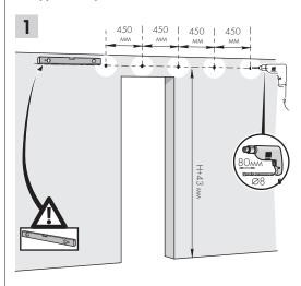
По уровню разметьте и просверлите отверстия в стене ( $\varnothing 8$  мм, глубина 80 мм) согласно схеме.
