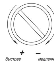
**Нельзя поворачивать винт более четырех оборотов против часовой стрелки, это может привести к выкручиванию винта доводчика, утечке масла и поломке изделия.**
