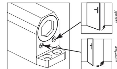
Закрытие дверного полотна в двух зонах регулируется винтами на корпусе доводчика:
