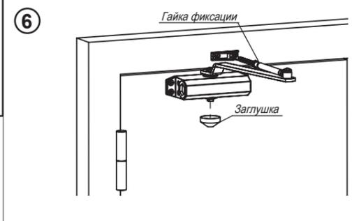
Зафиксируйте фиксирующую гайку на рычаге доводчика. Отверстие под винт, на корпусе с противоположной стороны доводчика, закройте декоративной заглушкой. Далее выполните регулировку доводчика.
