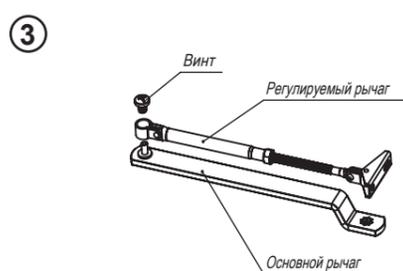
Детали рычажного механизма в комплекте поставки соединены между собой. Необходимо разъединить основной и регулируемый рычаг. После зафиксировать кронштейн рычага на дверном полотне или коробке (в зависимости от выбранного варианта).
