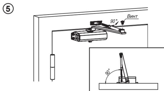
Выставьте длину регулируемого рычага проворачивая винтовую часть по или против часовой стрелки. Установите и зафиксируйте соединительный винт.
