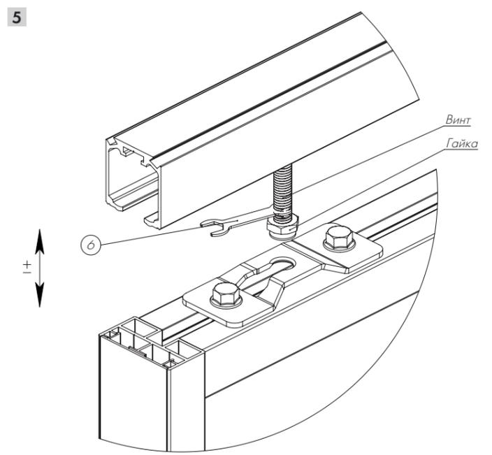
Навесить полотно на регулировочные винты. В случае необходимости, отрегулируйте положение полотна с помощью винта. Затяните винты фиксирующей гайкой при помощи ключа 6.
