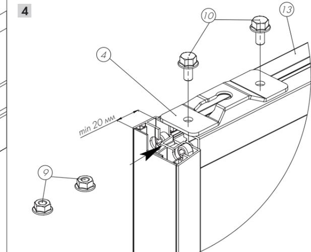
Поместить гайки 9 в горизонтальный профиль дверного полотна 13. Зафиксировать монтажные пластины 4 при помощи болтов 10.
