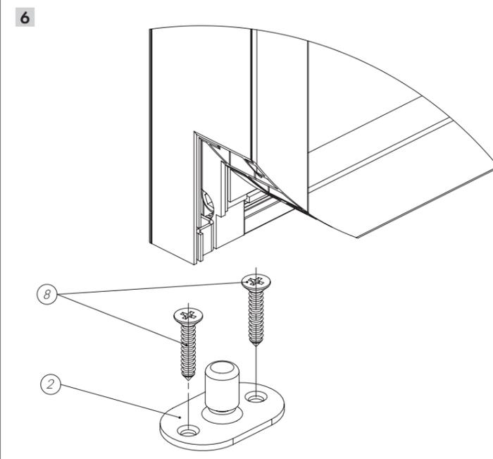
Зафиксировать нижний направляющий ролик 2 на полу с помощью саморезов 8.
