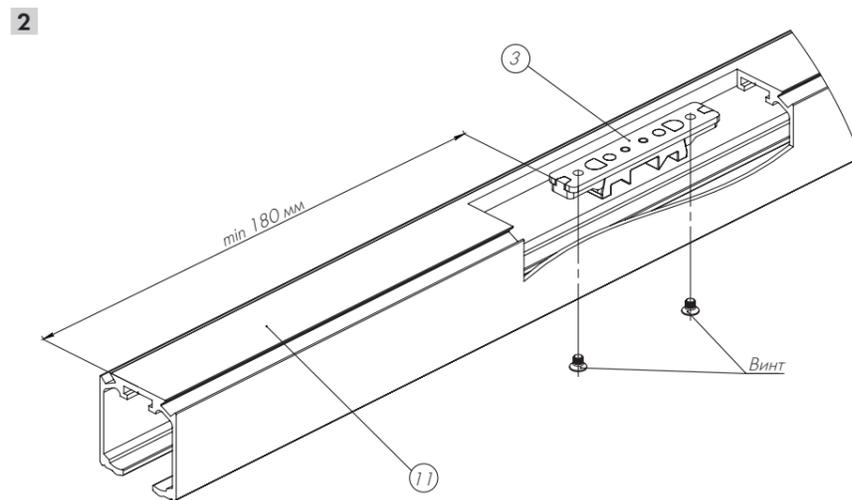
Зафиксировать стопоры доводчика 3 на расстоянии min 180 мм от торца верхней направляющей 11 с двух сторон с помощью винтов. Конечное положение стопора доводчика определяется конечным положением ролика с доводчиком.
