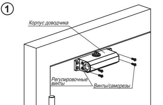
Произведите разметку согласно шаблону по типу установки. Просверлите отверстия и закрепите корпус доводчика винтами или саморезами.
