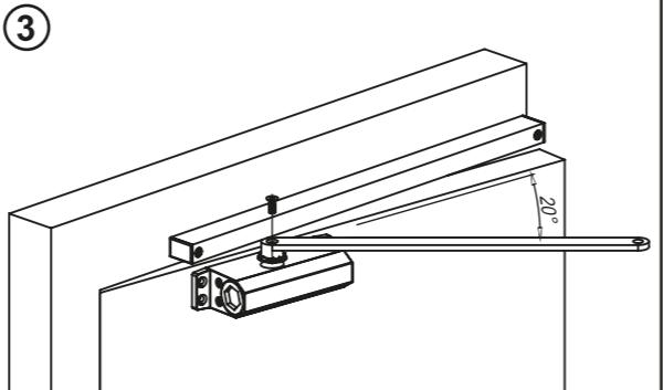
Зафиксируйте штангу на корпусе доводчика под углом 20° от дверного полотна с помощью винта.
