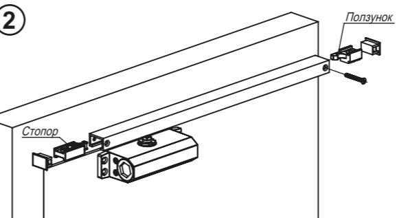
Закрепите направляющую саморезами или винтами, предварительно установив стопор и ползунок.
