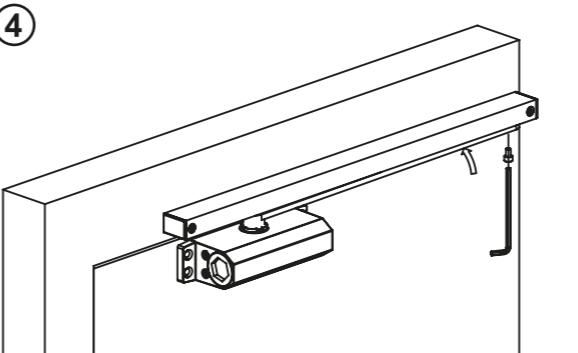
Заведите штангу дверного доводчика на ползунок направляющей и зафиксируйте винтом с помощью шестигранного ключа.
