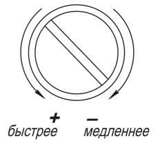
Регулировка производится двумя винтами, которые расположены на торце корпуса доводчика:
