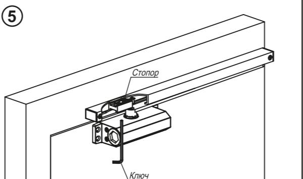
Определите положение стопора для фиксации полотна в открытом положении и затяните фиксирующий винт при закрытой двери. Для регулировки угла фиксации переместите стопор влево/вправо. Если фиксация полотна в открытом состоянии не требуется, ослабьте фиксирующий винт и вытащите стопор из направляющей.
