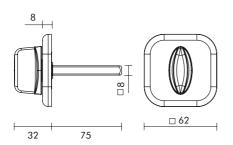
Поворотная ручка на квадратном основании Fuaro BKW8 XL без ответной части подходит для установки на металлические и межкомнатные двери. Разработана в составе комплекта ТОR XL, в который входят также поворотник, накладки на сувальду, цилиндр и броненакладки в едином дизайне. Продаётся как в составе комплекта, так и отдельно.
